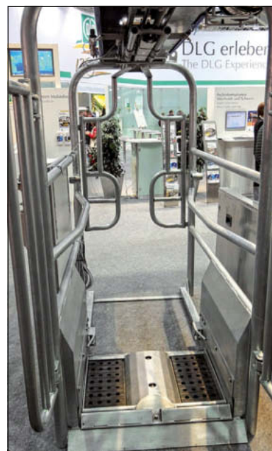
Die SprayCare-Pflegebox von DeLaval mit gesteuerten Ein- und Ausgängen.
