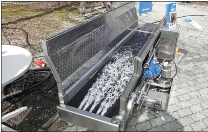
Bei der ClawCare-Anlage laufen die Tiere über Bodenmatten. Das Reinigen und Pflegen erfolgt nach dem Zwei-Phasen-Prinzip.
