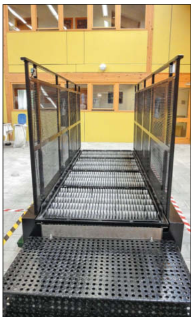
Auf die Klauenreinigung mit Bürsten setzt das System der Firma Huf und Klau.
